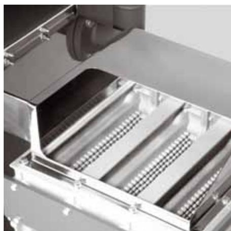
2. Particolare del collettore fumi in acciaio inox e del condensatore a elementi in alluminio a basse perdite di carico.
